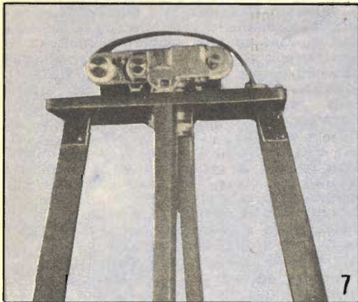
Veduta ravvicinata della piattaforma con il foro centrale per l'obbiettivo della macchina. La macchina installata è una Leica, ma qualsiasi altra macchina di media qualità a passo 24 x 36 potrà essere usata in luogo di quella. Nella foto è anche visibile la striscia di elastico, non completamente tesa.
