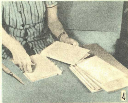
A sinistra: Distaccare con attenzione la copertina del libro da riparare; quindi tagliare via tutte le legature che tengono insieme i quinterni delle pagine, senza giungere a danneggiare la carta. A destra: Tagliare con attenzione anche i fili che servono a tenere insieme i fogli di ciascun quinterno; così facendo scomporre l'intera massa delle pagine.
